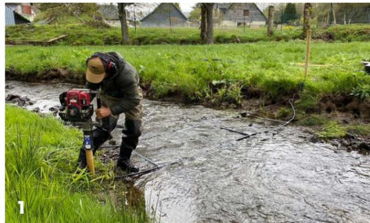
Photo 1 : Installation d'un récepteur fixe sur le bras de contournement.
