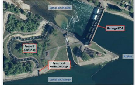
Construite en 2012, cette passe à poissons dans le département du Rhône, permet le franchissement du barrage EDF de Jons par les espèces piscicoles en connectant le canal de Miribel à celui de Jonage.
