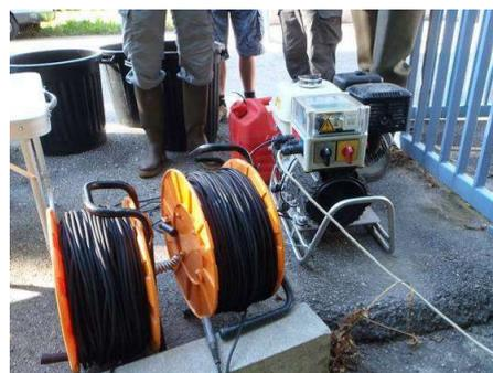
Le poisson, et plus particulièrement ses fibres nerveuses et musculaires, réagit à ce courant en adoptant une « nage forcée » vers le gradient de potentiel électrique le plus fort (l'anode). A proximité immédiate de l'anode, les opérateurs capturent les poissons ainsi attirés, au moyen d'épuisettes pour les transférer dans des viviers, à l'abri du champ électrique.
